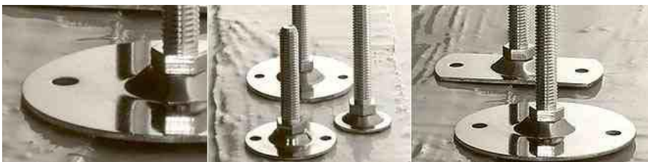
Teller und Schraube aus Stahl mit Kreuzschlitz* - galvanisch verzinkt - Sechskant SW 14 – drehbar
